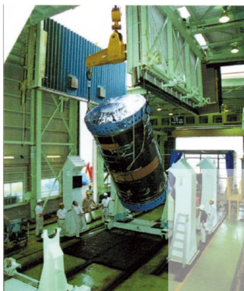
モータ吊込み作業
