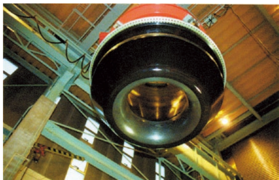
燃焼前のノズルスロート部
