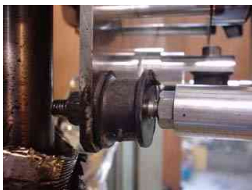
図3 エンジンマウント部防振ゴム
