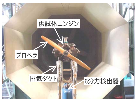
図2 供試体設置状況（上流側より見る）
