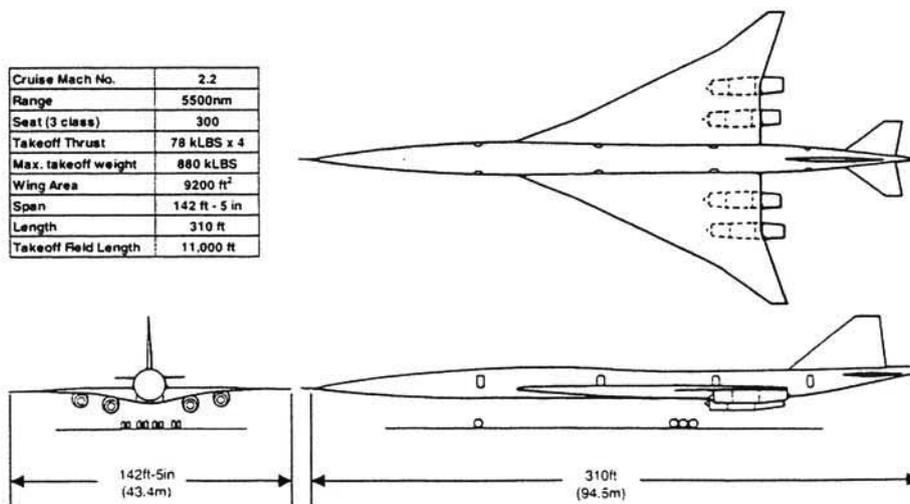
Fig. 5 Airplane configuration<sup>3)</sup>
