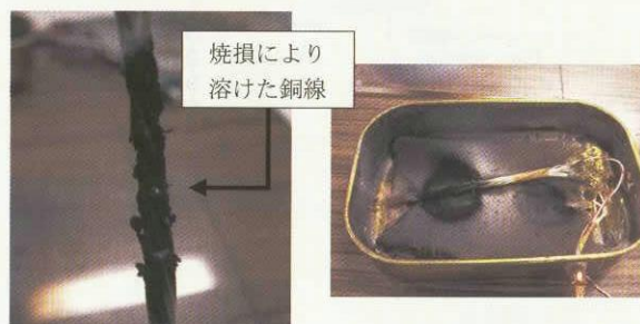
図14 焼損後の電力ハーネス外観
