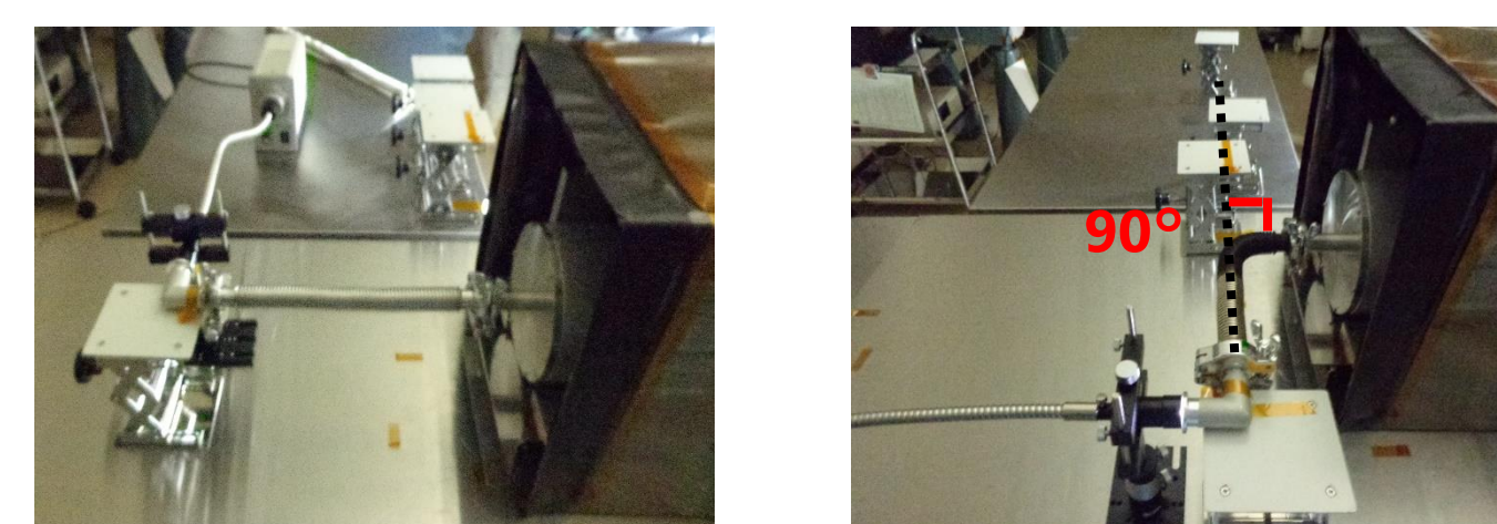
図5: 黒色メッキ効果の検証セットアップ (左写真) フレキBを 0^\circ 曲げた際の実験写真。 (右写真) フレキAを黒色メッキを施した箇所 90^\circ 曲げた際の実験写真。
