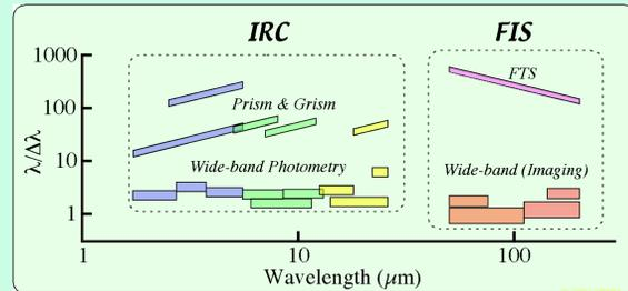
▶ 焦点面観測装置: 「あかり」の観測波長帯と波長分解能
