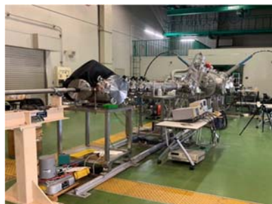
バリスティックレンジ (ISAS)
