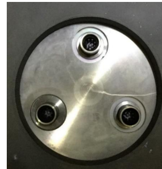
図 2. チャンバ内壁にマウントされた SWS を構成する 3 基の MPD アークジェット
