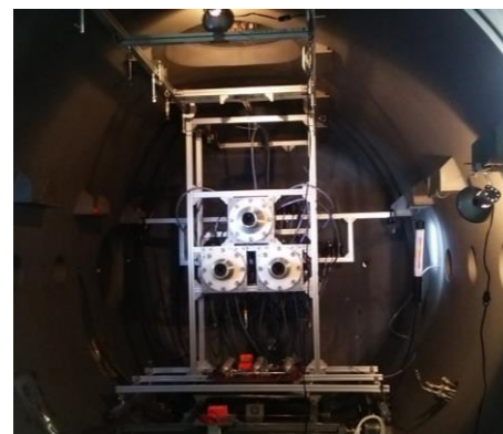
図 3. チャンバ内部に設置された SWS を構成する 3 基の MPD アークジェット
