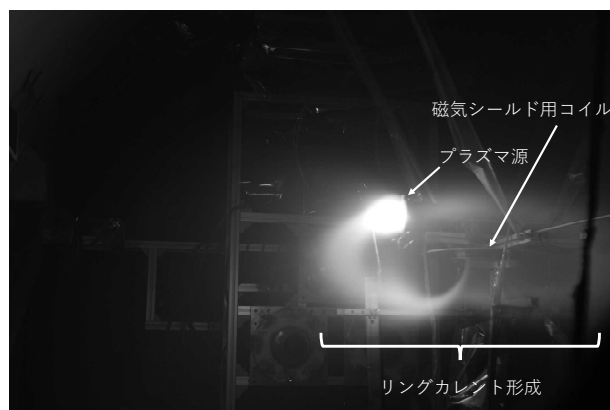
図6 リングカレント形成時の撮像写真
