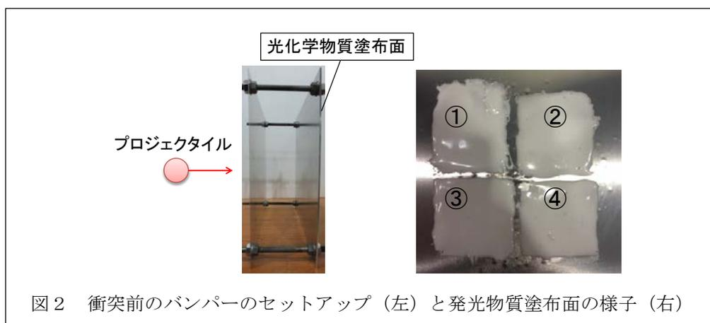
図 2 衝突前のバンパーのセットアップ (左) と発光物質塗布面の様子 (右)
