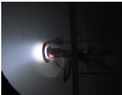
図7 LaB 6 熱陰極を用いたプラズマ生成の撮像
