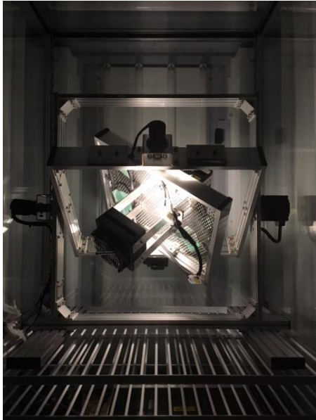
Fig. 3 太陽光模擬光源ユニット搭載3Dクリノスタット 光源ユニットから光を照射しながら、植物栽培が可能である。
