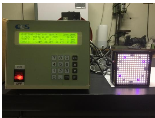
Fig. 1 太陽光模擬光源ユニット 縦横 10 cm 四方の中に、4 種の LED 光源を埋め込み、照射面での各種 LED から放射される光は均一になるように設計されている
