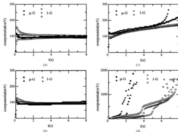
Fig. 5 Time variation of anodic overpotential (effect of current density): (a)  $i=0.2 \text{ A cm}^{-2}$ ,  $iR=53 \text{ mV}$ ; (b)  $i=0.5 \text{ A cm}^{-2}$ ,  $iR=130 \text{ mV}$ ; (c)  $i=0.8 \text{ A cm}^{-2}$ ,  $iR=210 \text{ mV}$ ; (d)  $i=1.4 \text{ A cm}^{-2}$ ,  $iR=370 \text{ mV}$  (after Ref. 4)
