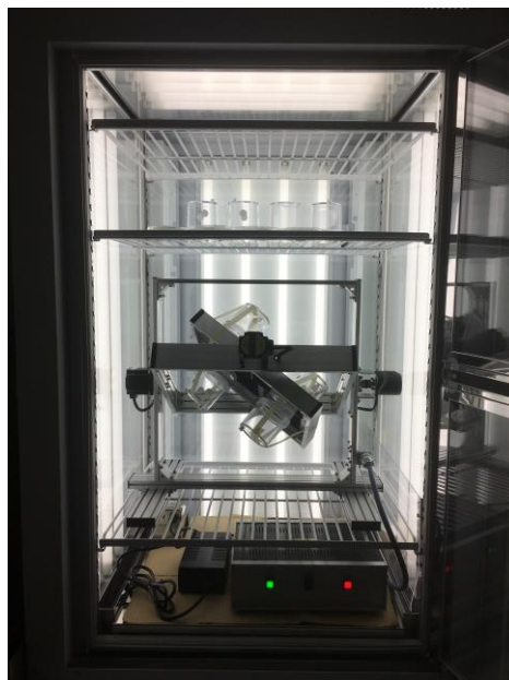
図 2. 3D クリノスタットを利用した疑似微小重力環境下における紫外線影響評価試験
