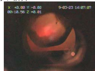
図2. 0.01 G のときの超流動ヘリウムの界面の様子。左上の数字はx,y,z方向のGの値である。
