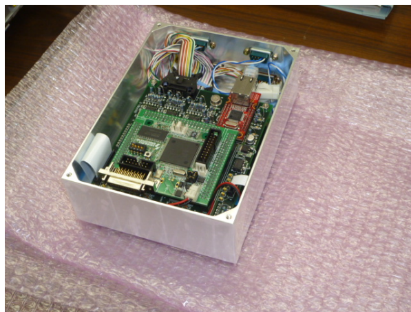
Fig.3 試作した制御コンピュータ。180×130×60
