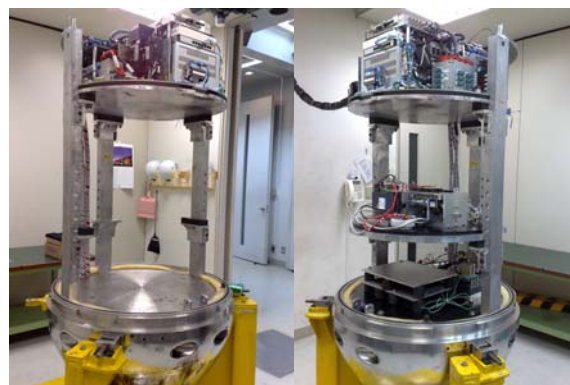
図3、MGLABの落下カプセルに乗せた実験装置の写真。
