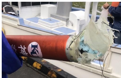
図10 破損した計測モジュール
