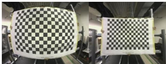
図 11 歪み補正前 (左) と歪み補正後 (右) のチェッカーボード画像
