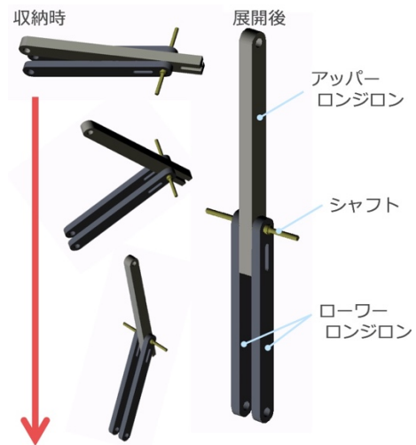
図 1 伸展マストの伸展におけるロンジロン 1Unit の展開挙動
