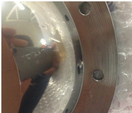
図11 KCに生じた傷の例 (左：DOR球部，右：DORピース斜面)
