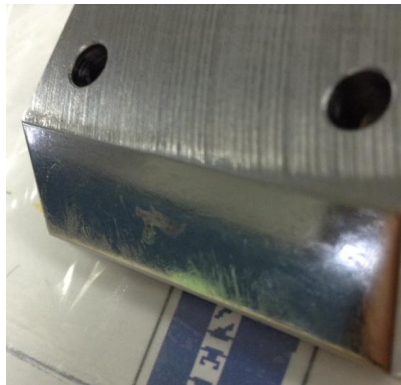
図11 KCに生じた傷の例 (左：DOR球部，右：DORピース斜面)
