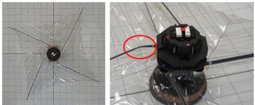
図5 一気展開後のブームの座屈（重力補償なし）
