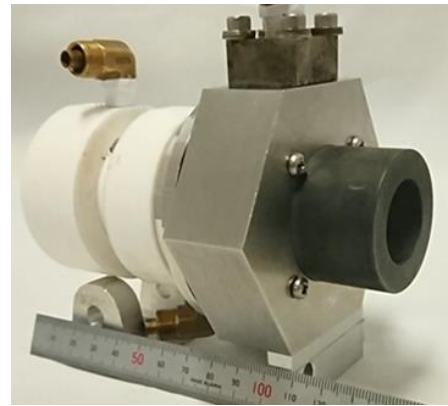
図5 アノード輻射冷却式アークジェットスラスタ本体写真
