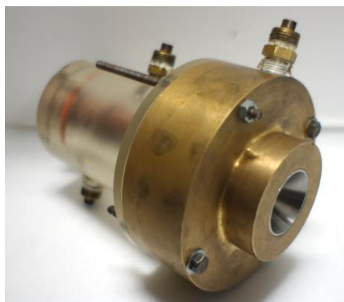
図7 水冷式アークジェットスラスタ本体写真
