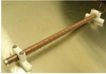
図9 作成した磁気トルカ
