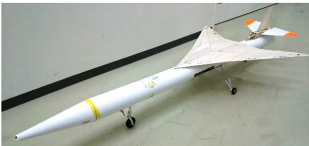
図8. 試作された1/3スケール縮小機体
