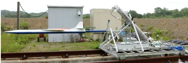
図9. 舵面空気モーメント計測のための高速走行試験
