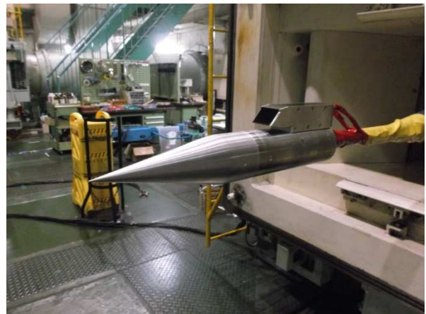
図10. インテーク抗力推定のための遷音速風試
