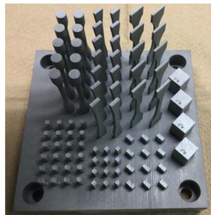
図6 3D造形により作成したタングステン材料試験片
