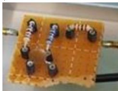
図5 積分回路(左)と回路図(右)
