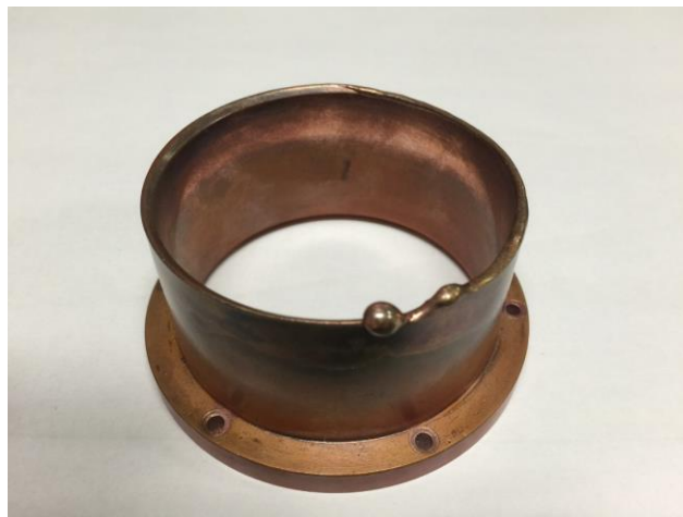
図 17 融解したアノード外周部
