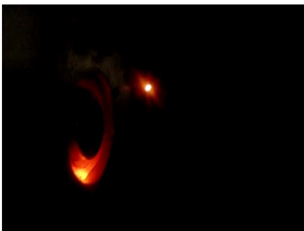
図 16 作動停止直後（スラスタ側面）
