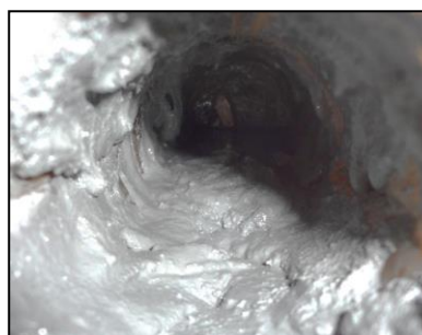
Fig. 3.2 蠕動運動型混合器で捏和した推進薬スラリ
