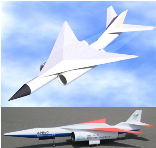
図1 オオワシⅠの概念図（上：M2006モデル）と prototype 飛行実験機（下）
