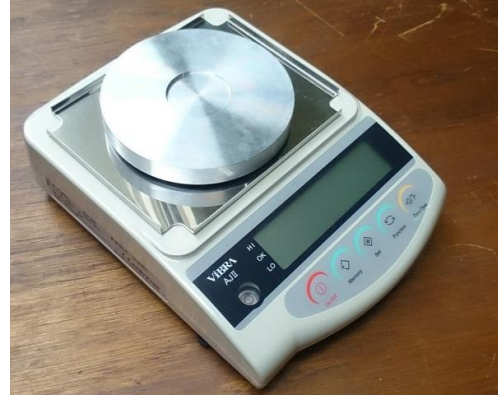
Fig.6 採用した音叉型電子天秤
