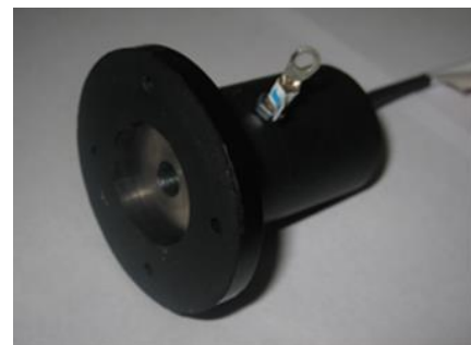
a) 1号機用の PPT の外観
