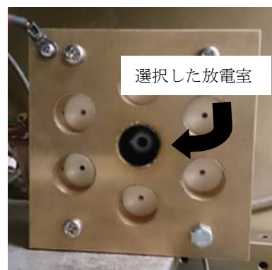
図 12 実験後の新型多放電室型 PPT
