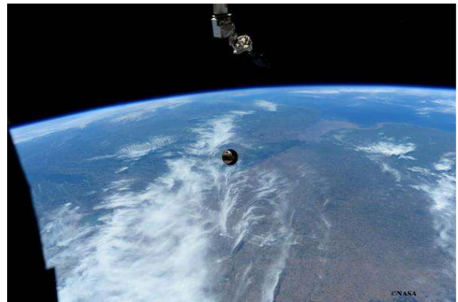
図3 NASA/Cyclops での ISS から球形小型衛星放出
