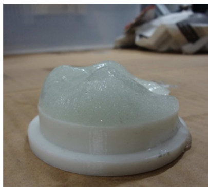
図4 作製したポリアクリル酸ナトリウム / ガラスビーズスラリ
