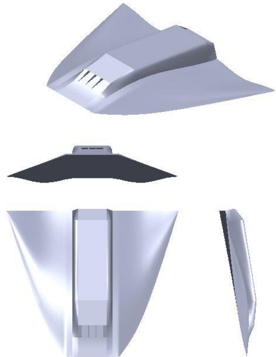
図8 最適化されたTSTOブースター段設計
