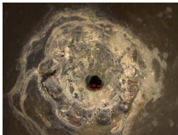
Fig. 3-2 SHP163 系分解ガス噴射後のダイバージェントノズル損耗.
