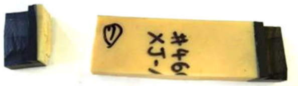
図 9 材料破壊の様態 (LT-5 およびポリオレフィン系プライマ)
