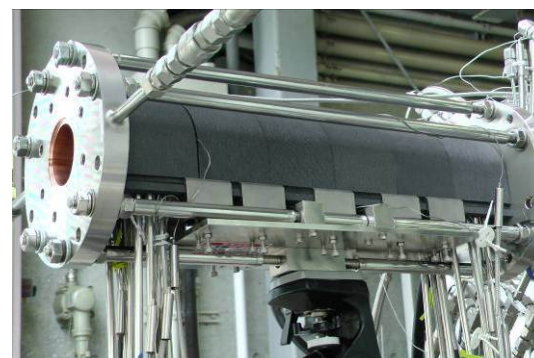
図4 組み上がった状態の C/C 複合材冷却構造
