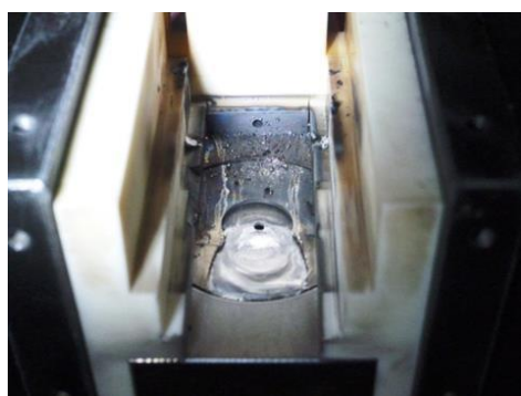
図 1 陰極の損耗の状態
