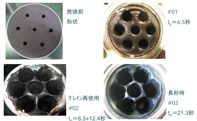
図5-6 マルチポートグレイン燃焼前後形状
