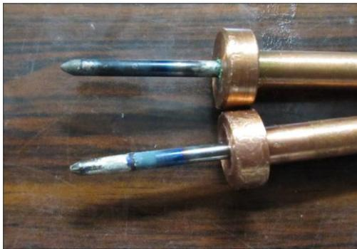
Fig.4-1 SHP163推進剤と水のカソード損耗
