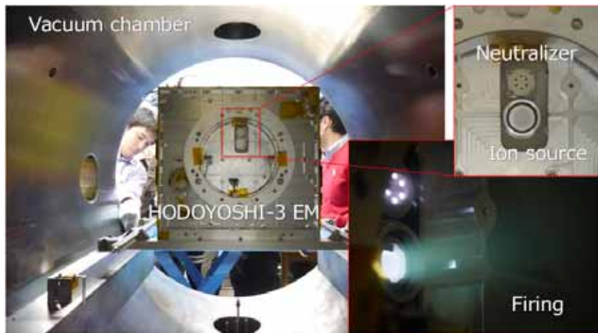
Fig. 12. MIPS-EM coupling test with HODOYOSHI-3 EM
