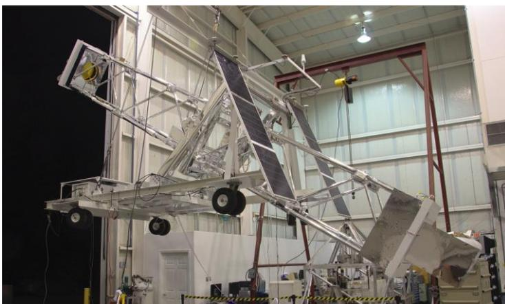
図 1: X-Calibur 気球の全体写真。2018 年 12 月の南極フライトで利用。全長~8m。左上: 硬 X 線望遠鏡、右下: 偏光計。次回 2021 年のフライトでは日本から FFAST 衛星用の硬 X 線望遠鏡を提供する。焦点距離が 12m なので、ゴンドラも長くなる。
