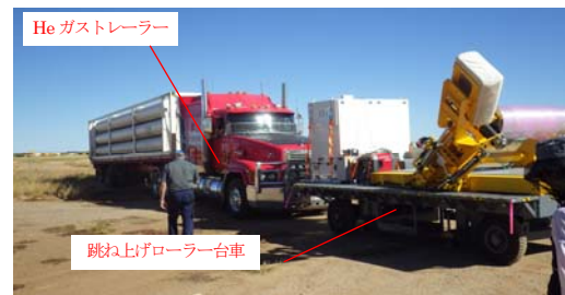
図1. 跳ね上げローラー台車(改良前)
