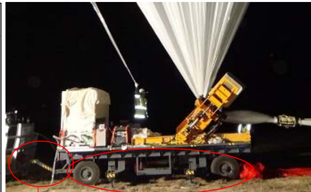
図 17. 跳ね上げローラー台車(改良前)
