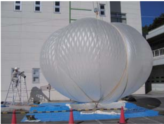
図 3. NPB01-1 試験気球で確認された展開不安定性
