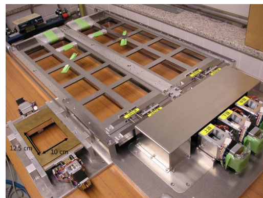
図 1. (左) 多段シフター1号機、口径面積 125 \text{ cm}^2 , 2011 年気球実験で使用 (右) 多段シフター2号機、口径面積 3780 \text{ cm}^2 , 2015 年気球実験で使用
