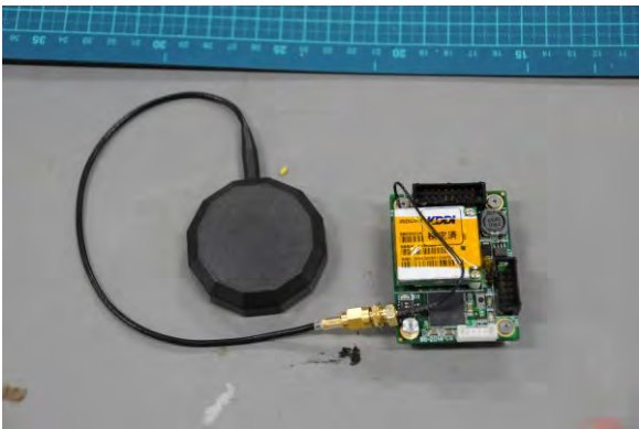
図 3: イリジウム SBD モジュール (9603 型) を用いた通信装置
