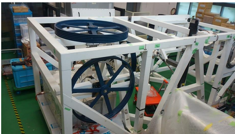
図 2. リアクションホイール (3 軸) 取付状態
